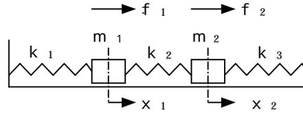
図 3.3.2 ばねで引っ張られた2個の質点の運動
