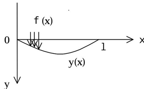
図 3.1.2 荷重による弦のたわみ
